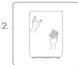
Reinigen Sie das Gehäuse mit einem weichen, trockenen Tuch. Wenn das Gerät extrem verschmutzt ist, verwenden Sie ein mildes Reinigungsmittel. Wischen Sie den Luftentfeuchter mit einem leicht feuchten Tuch ab. Besprühen Sie das Gerät niemals mit Wasser.
